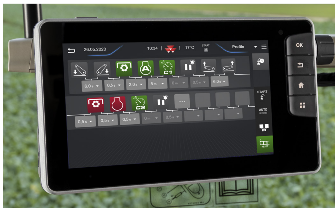
GESTIONE MANOVRE FINE CAMPO è disponibile attraverso Datatronic 5 in versione Exclusive (opzionale nella versione Efficient)...
