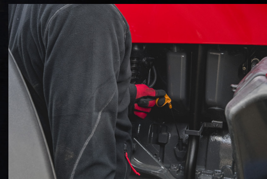
L'assale anteriore e il design affusolato del cofano garantiscono un facile accesso all'asta di livello e ai filtri dell'olio motore.
