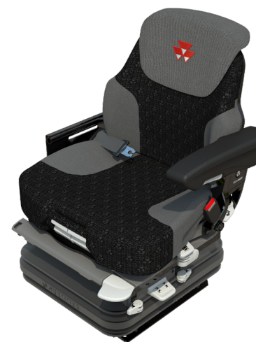
VERSIONE EXCLUSIVE Sedile girevole standard con sospensione pneumatica automatica, poggiatesta, ammortizzatore longitudinale, sistema di riscaldamento e regolazione lombare pneumatica.
