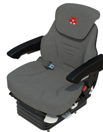
VERSIONE ESSENTIAL Sedile girevole standard con sospensione pneumatica, poggiatesta, ammortizzatore longitudinale e regolazione lombare meccanica.
