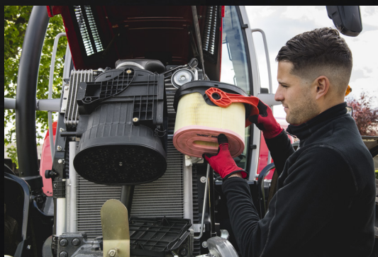
Altrettanto semplici sono l'accesso e la pulizia del filtro dell'aria del motore.
