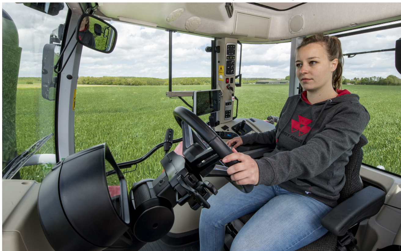
VERSIONE ESSENTIAL Sedile girevole standard con sospensione pneumatica, poggiatesta, ammortizzatore longitudinale e regolazione lombare meccanica.
