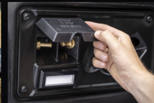
Il pacchetto Professional, disponibile su richiesta, offre inoltre due prese elettriche da 12 V integrate nel serbatoio del carburante per alimentare una pompa esterna del carburante o dell'AdBlue®.
