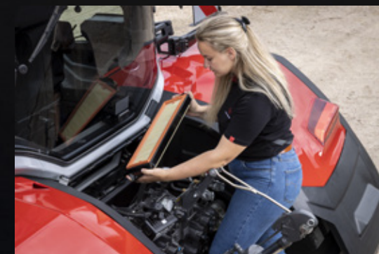
Facile accesso per la rimozione e la pulizia del filtro dell'aria della cabina
